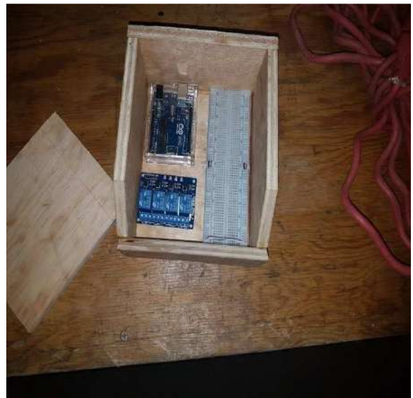
Imagen 2. Caja de madera donde iría instalado el Arduino, el protoboard, y el relevador junto con todo el cableado de los sensores y componentes.
