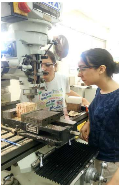
Figura 2. Maquinado del laberinto del NanoMaze
