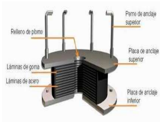
Figura 1. Composición de un aislador sísmico.
