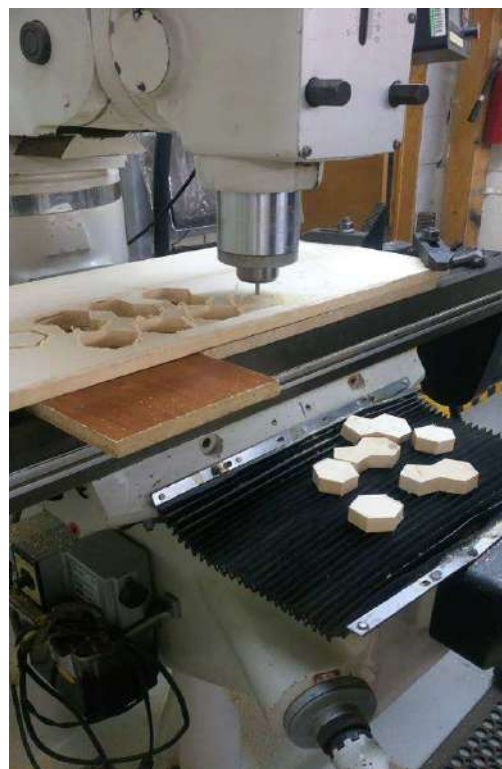
Figura 4. Corte de las piezas de ADN-Block en CNC
