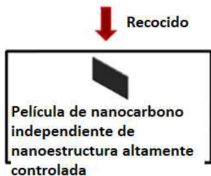
Fig. 3. Recocido de la película.
