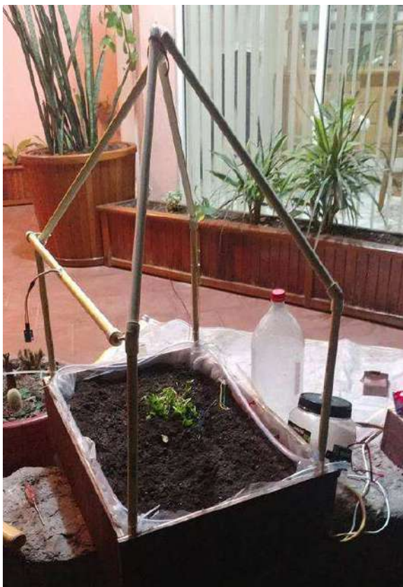
Imagen 4. Invernadero funcional con los sensores de temperatura, humedad, con la bomba de agua y el foco, en este punto ya podíamos tener resultados en la pantalla de LCD.
