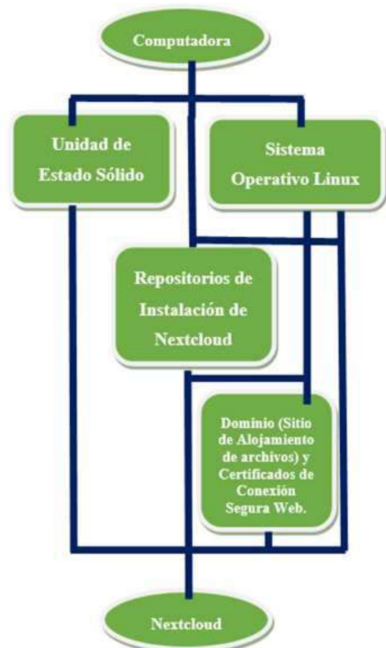
Figura 1. Diagrama de la nube personal, procesos clave para su funcionamiento.
