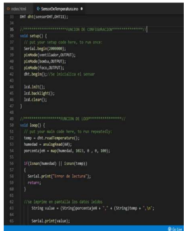
Imagen 1. Parte del código del Arduino donde se leían los datos de los sensores y se convertían para poder ser desplegados en la pantalla LCD que se encuentra a un lado del invernadero.
