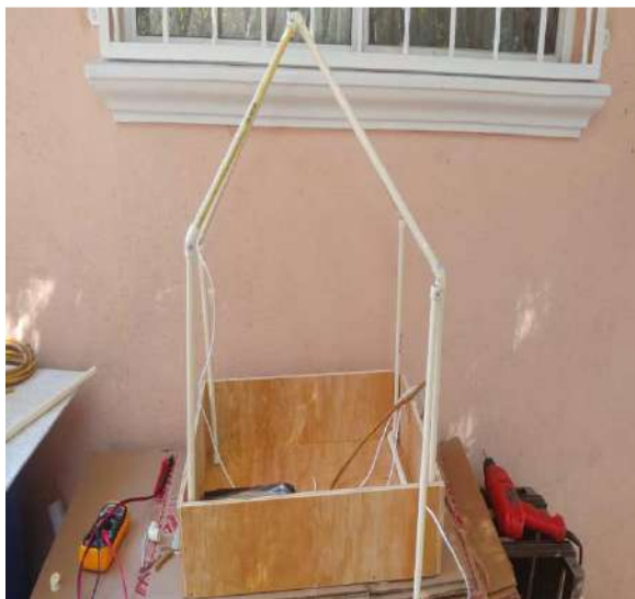
Imagen 1. Cajón de madera, con el prototipo de como iría la entubación del cableado para los sensores, el abanico y el foco.
