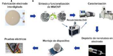
Figura 1. Diagrama de las etapas para la fabricación del sensor nanoestructurado.
