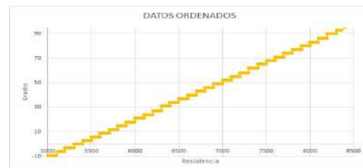
Figura 6 Grafica que muestra datos de salida (grados) contra posición <ordenados>
