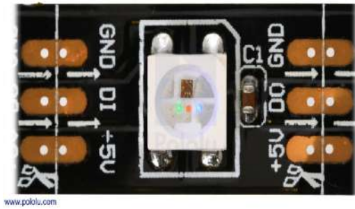
Figura 1. Vista de un LED WS2812B.
