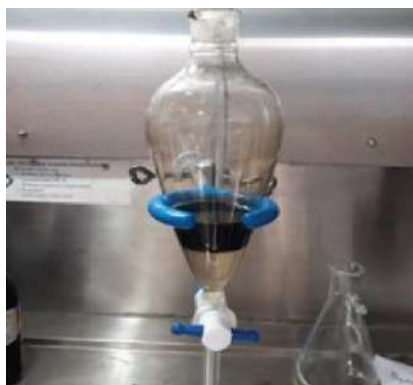
Imagen 4. Precipitación de la capa traslúcida (disolución de cafeína y cloroformo) al fondo del frasco.
