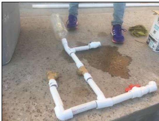
Figura1 Estructura de la bomba de ariete.
