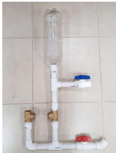
Figura 2 Estructura final del golpe de ariete.
