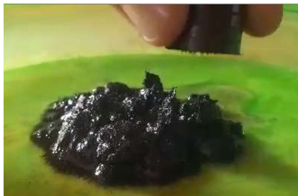
Fig 4.2 Levantamiento del ferrofluido generando espinas.
