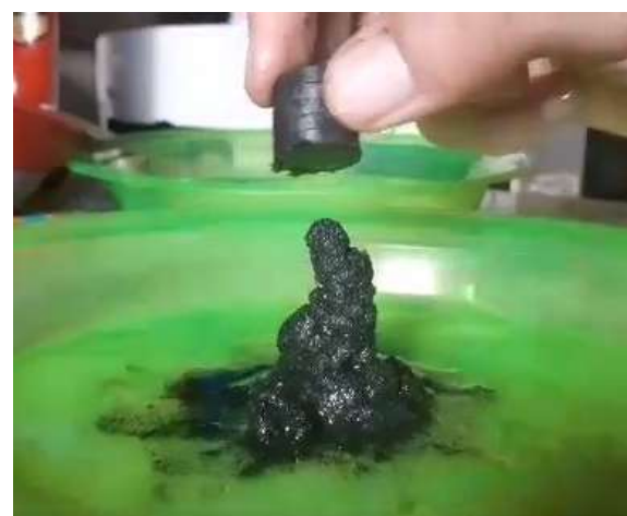
Fig 4.1 Atracción del ferrofluido hacia un imán, verticalmente.
