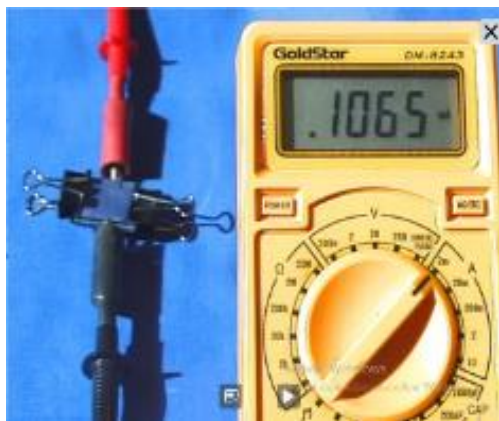
Figura 6. Pruebas realizadas a la célula solar para observar su capacidad de recepción de los rayos solares y conversión a corriente eléctrica.
