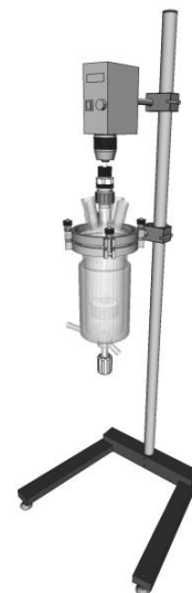
Figura 4. Biorreactor con las piezas ensambladas, modelo de SpinChem® Vessel V3 y RBR S3 Plus con membrana de politetrafluoretileno (PTFE).
