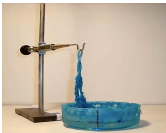
Fig. 1.4 Imagen que representa la formación de cristales verticalmente con el apoyo de un hilo.
