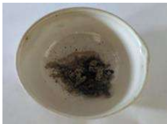
Figura 5. Nanopartículas obtenidas después del calcinamiento a 400 °C.
