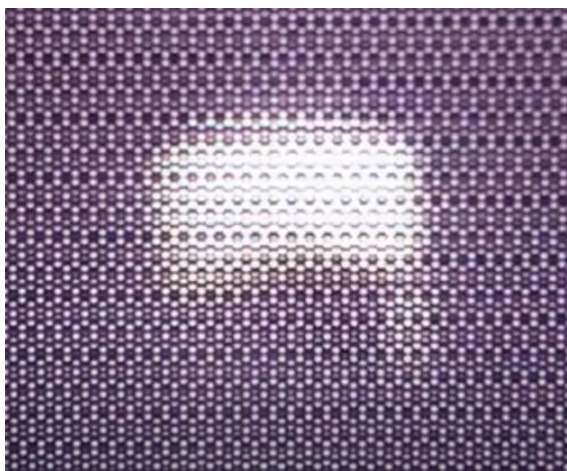
Imagen 5. Visualización del plasma obtenido visto desde afuera de un microondas
