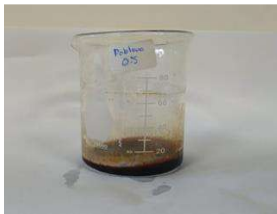
Figura 4. Consistencia viscosa del extracto con el cloruro de estaño después de un tratamiento térmico en baño de agua.
