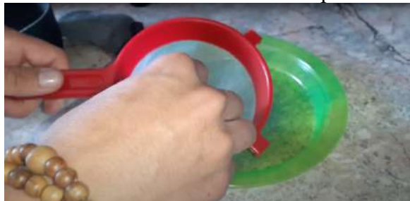
Figura 3.3 Tamizado de la fibra metálica.
