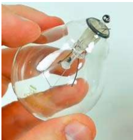
Figura 3. Imagen del foco después de retirar el recubrimiento metálico y el pegamento. En la parte superior de la imagen se puede ver el bastoncillo que se retira para crear el agujero por el cual se introduce el líquido al foco.
