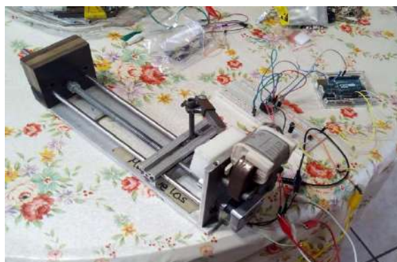
Imagen IV: Mini torno conectado al driver y arduino.
