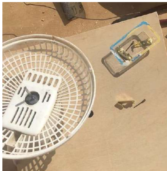
Figura 2 Foto del motor de ventilador antes de ser colocado en la caja de madera
