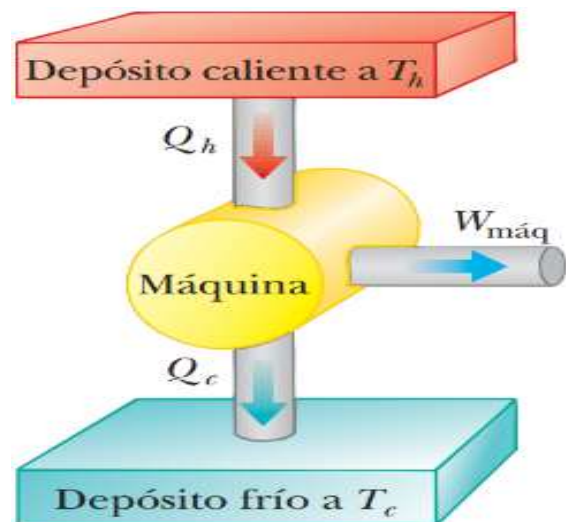
Figura 1. Funcionamiento de una máquina térmica. La máquina absorbe energía Q_h del depósito caliente y expulsa energía Q_c al depósito frío, ambas en forma de calor; realizando un trabajo W_{máq} [2].
