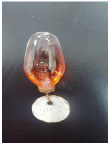
Figura 4. Alambre de cobre amarrado a la moneda e incrustado en el pegamento para mantenerse unido a la bombilla.
