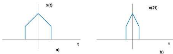
Figura 3. Compresión en el tiempo de la señal x(t) a) señal original; b) señal comprimida por un factor de 1/2
