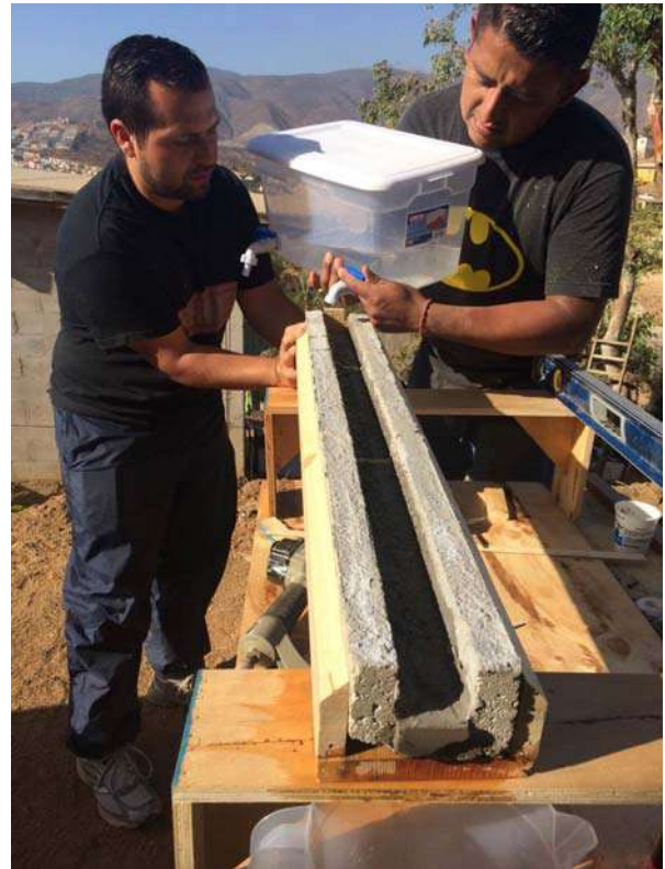
Imagen 3. Prueba de aforo en canal rugoso.
