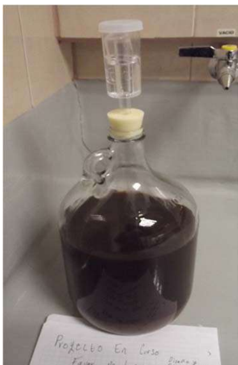
Figura 1. Reactor tipo Batch utilizado para llevar a cabo la producción de una bebida alcohólica mediante la fermentación de carbohidratos.
