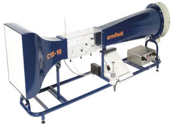
Figura 1. Túnel de viento instalado en CITEC.
