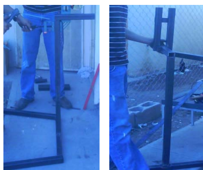
Figura 6. Configuración de la grúa biomédica con las patas, barra de apoyo y el brazo.
