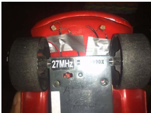
Imagen 1. Fotorresistencias colocadas en la parte frontal del carro hacia abajo para evitar perturbación por luz solar.
