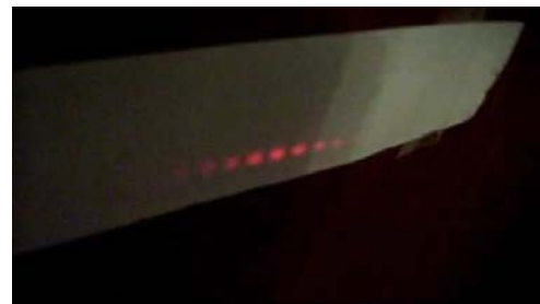
Figura 3.- Esquema Mostrando los resultados de nuestro experimento, observamos del experimento en donde se aprecia el espaciado generado por la dos ranuras.
