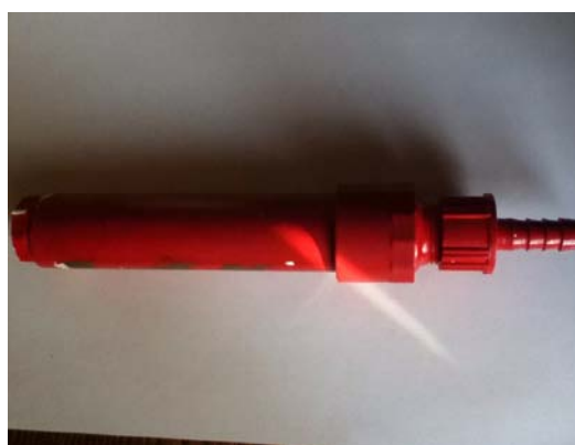
Figura 4. Filtro nanoestructurado ensamblado. En la figura se puede apreciar el filtro, el cual está subdividido en distintas secciones tales como zeolita, nanopartículas de plata soportadas con sílice-alúmina, mallas de aluminio y fibra de vidrio.
