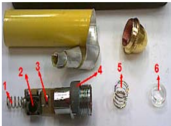
Figura 3. Puntero láser desarmado, mostrando cada una de las partes de las cuales esta compuesto.
