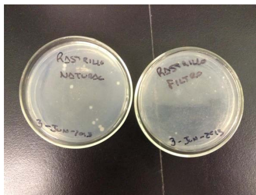
Figura 2. Siembra antes (izquierda) y después (derecha) del filtro utilizando rastrillo. En esta figura se puede observar que hubo un crecimiento menor usando el filtro en comparación del agua sin filtrar.
