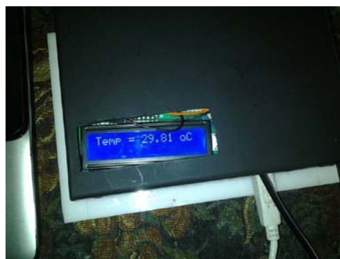
Figura 4. Imagen del prototipo del calorímetro digital implementado.
