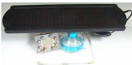
Figura 4. A la izquierda el Electrolizador con su reservorio alimentado de un panel solar.
