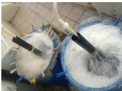
Figura 6. Sistema de aeración operando, nótese que la espuma de la estación 2 (izquierda) presenta un color más oscuro característico de una mayor cantidad de suciedad, mientras que la estación 3 presenta un color blanco característico de una menor cantidad de suciedad en la espuma.
