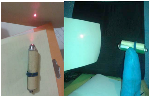
Figura 1.- Esquema del experimento en donde se aprecia el apuntador láser y la pantalla donde incide el haz.
