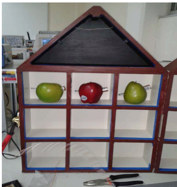
Figura 1. Dos manzanas y dos peras con coples de cobre y grapas galvanizadas en la casa para el circuito.
