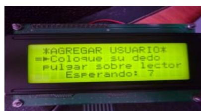
Figura 8. Visualización en LCD de colocar dedo pulgar en lector.
