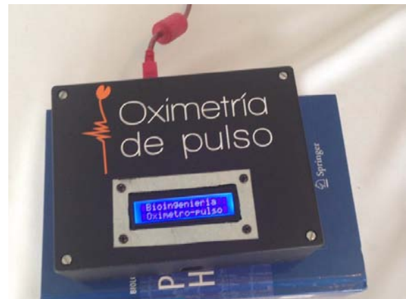
Figura 3. Vista exterior del equipo de medición de oxígeno en la sangre.
