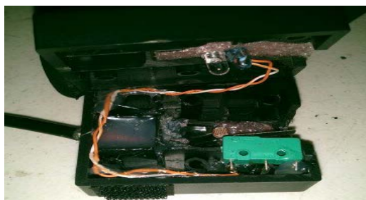
Figura 1. Configuración interna del sensor de SAO_2 y pulsos cardiacos.
