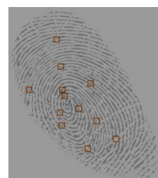
Figura 1. Extracción de minucias de la huella dactilar.
