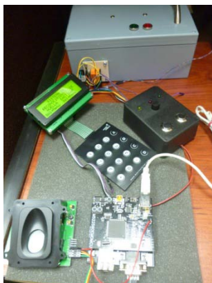
Figura 11. Sistema de acceso seguro de caja fuerte basado en huella dactilar y encriptado caótico.
