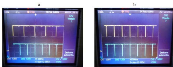
Figura 5. Verificación de sincronía con osciloscopio en configuración de nueve luciérnagas a) desacopladas, señales de dos LED rojos (dos luciérnagas desacopladas) elegidos al azar, cada luciérnaga posee su propia frecuencia de parpadeo (no existe sincronía). b) acopladas, sincronización de parpadeos, existe sincronía.
