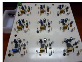
Figura 4. Construcción de nueve luciérnagas en placa fenólica 17 x 19 cm.
