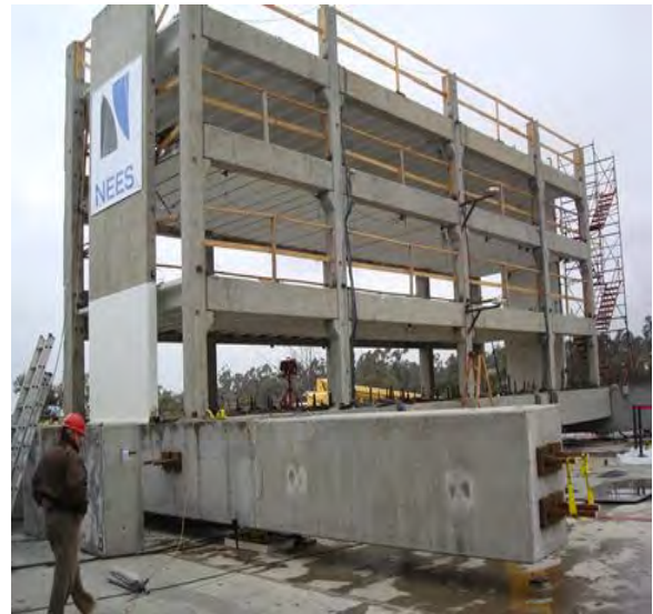
Figura 4 Fotografía de una estructura de concreto a base de marcos. El edificio está sobre una mesa vibratoria en la Universidad de California en San Diego y además cuenta con aislamiento sísmico (Filtros Sísmicos Valencia).
