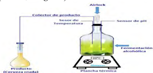
Fig. 1: Diseño de biorreactor tipo batch. El contenedor está construido a base de vidrio y provisto de instrumentos/dispositivos de medición y control.
