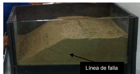
Imagen 1. Modelo físico de deslizamiento de talud, donde se provoca la línea de falla que se denomina rotura por talud.
