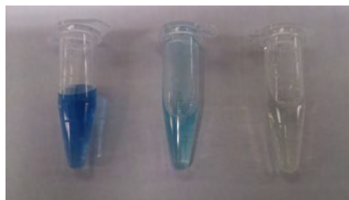
Fig. 4 Decoloración de AB185 utilizando lacasa libre. Inicio de la reacción (izquierda), reacción después de 1 minuto (centro) y reacción después de 2 minutos (derecha).
