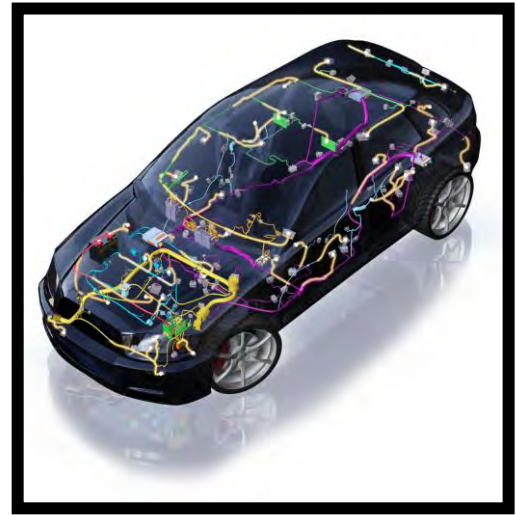
Figura 1.1 Esquema del sistema de arneses Automotrices en un auto tipo sedán.
