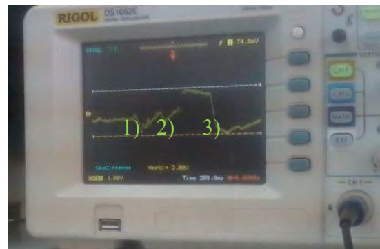
Fig. 4.1. Típica señal de EOG. En esta foto se observa cuando la señal es cero (1), cuando la mirada se encuentra abajo (2) y cuando la mirada se encuentra arriba (3) y baja.
