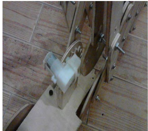
Figura 4. Motor montado en el mecanismo de rueda excéntrica.
