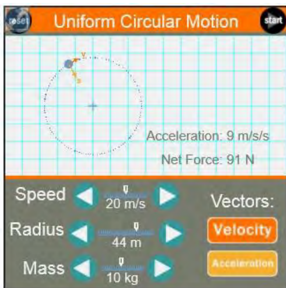
Figura 5. Visualización de los vectores de velocidad y aceleración © Physics classroom [4].
