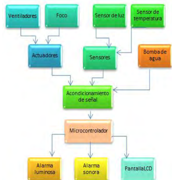
Fig. 2 Diagrama de bloques del sistema de control en el invernadero hidropónico.
