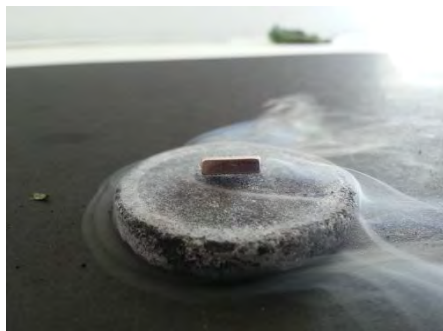
Imagen 1. Efecto Meissner. Imán levitando sobre la pastilla de \text{YBa}_2\text{Cu}_3\text{O}_7
