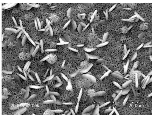
Fig. 8 Vidrio H_3 desvitrificado a 600 °C , 6 h, lixiviado a 150°C durante 6 horas.
