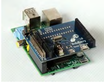
Fig.2 Raspberry pi y Arduberry (arriba), Arduberry montado sobre Raspberry pi para comunicación serial (abajo).
