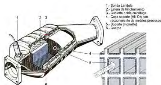
Esquema interno de un catalizador de 3 vías
