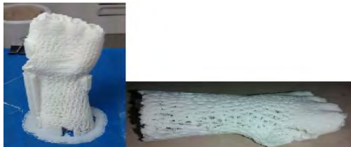
Figura 5. Modelo impreso con soportes y base (izquierda). Modelo limpio una vez retirados los soportes de impresión (derecha).
