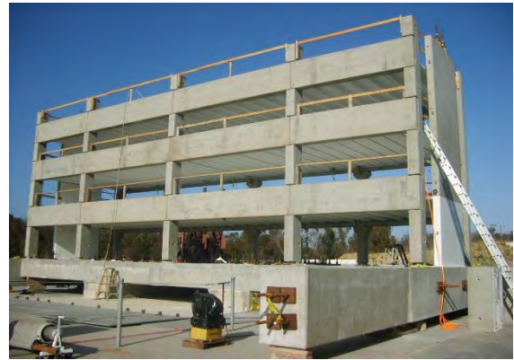
Figura 8 Fotografía del edificio de concreto prefabricado sobre la mesa vibratoria de Englekirk Center de la Universidad de California en San Diego donde se utilizó el Filtro sísmico [6].
