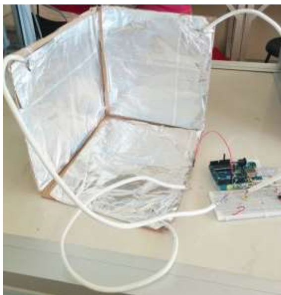
Figura 3. Montaje de la interfaz con los tres paneles de aluminio.
