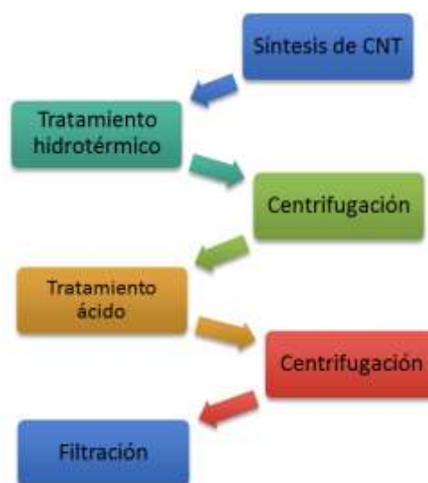
Fig. 3. Diagrama en la elaboración de los buckypapers.
