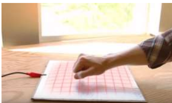
Figura 1. Simulación del tiempo de carga más corto al situarse en el punto más cercano al panel de aluminio.
