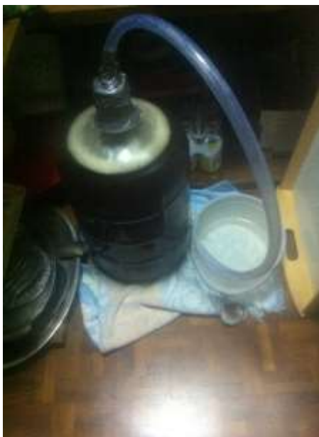
Imagen 2. Biorreactor utilizado para el proceso de fermentación
