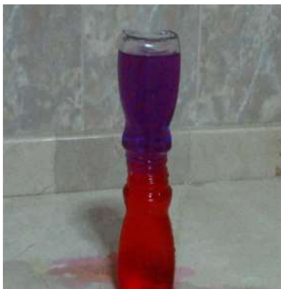
Figura 1. Demostración de separación de fases debido a los cambios de densidad provocados por un aumento en la temperatura. El embase de arriba contiene agua caliente (violeta), mientras que el embase de abajo contiene agua fría (rojo).
