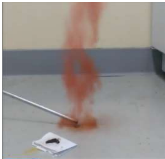
Figura 2. Imagen después del contacto del objeto con \text{NI}_3 . La explosión genera la producción de un gas púrpura, característico del yodo suspendido en una fase gaseosa del \text{N}_2 .
