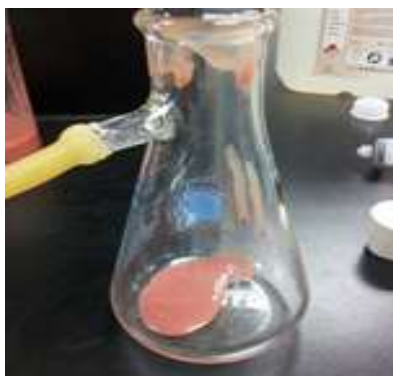
Figura 3. Sistema para reacción de descomposición de peróxido de hidrógeno armado.
