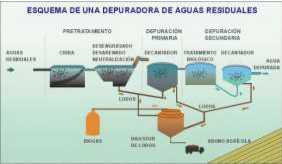
Figura II. Etapas generales de un proceso de tratamiento de aguas residuales convencional.
