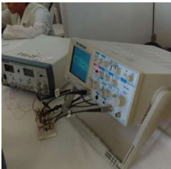
Imagen 3. Generador de caos en funcionamiento, siendo analizado por un osciloscopio
