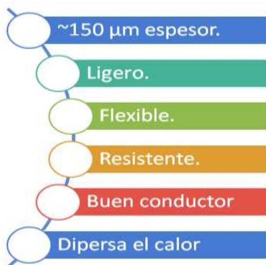
Fig. 1. Algunas características importantes de los buckypapers.
