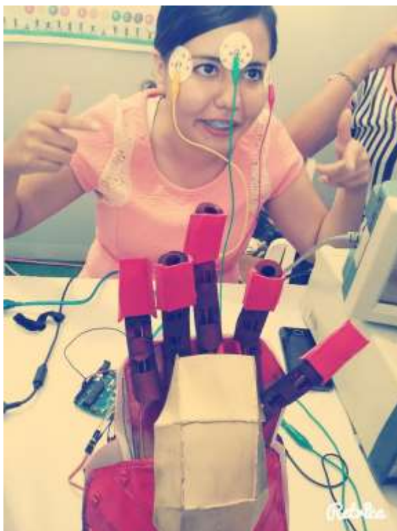
Figura 4 Sujeto de prueba conectado al E.O.G y Arduino para controlar la prótesis. Foto tomada por: Fernanda Morales.
