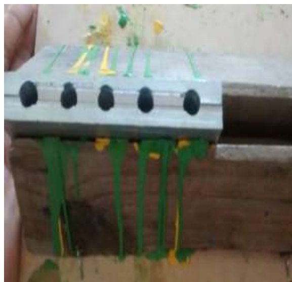
Figura 2. Molde utilizado par formar crayolas largas
