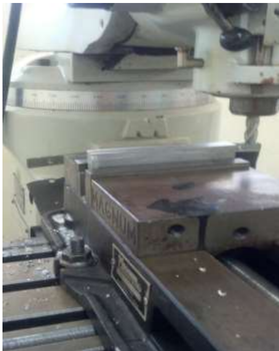
Figura 1. Aplicación del fresadora en la pieza de aluminio para formar el molde de cuadros
