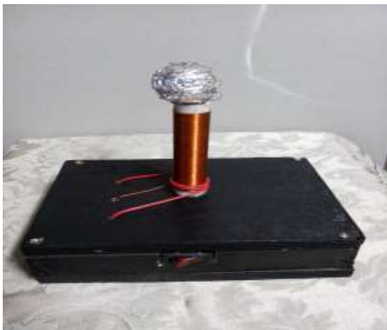
Imagen3: Bobina de tesla terminada
