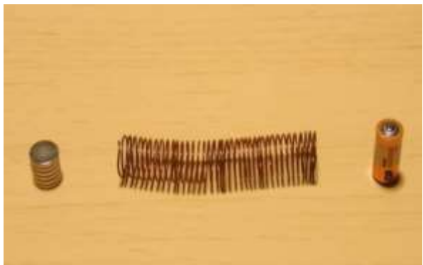
Figura 4 , imagen de los imanes de neodimio y del resorte de alambre de cobre y la batería.
