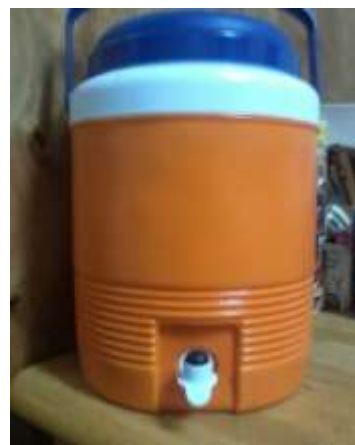
Fig. 3.2 Biorreactor utilizado. Por sus características, permitió la incubación del producto a 43°C por 12 h.
