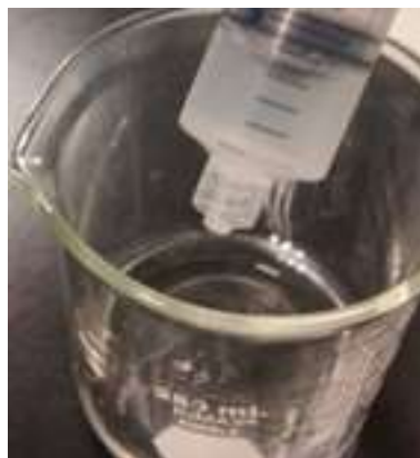
Figura 5. 20 ml extraídos de peróxido de hidrógeno con jeringa.
