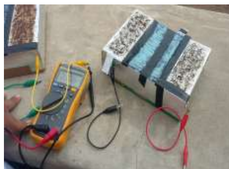
Figura I.4. Medición del voltaje en la celda finalizada en exposición al sol.
