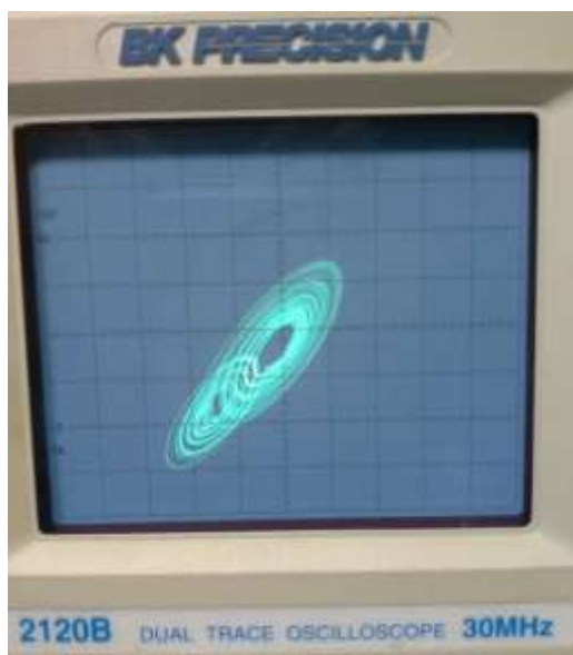
Imagen 4. Atractor visto en la pantalla del osciloscopio
