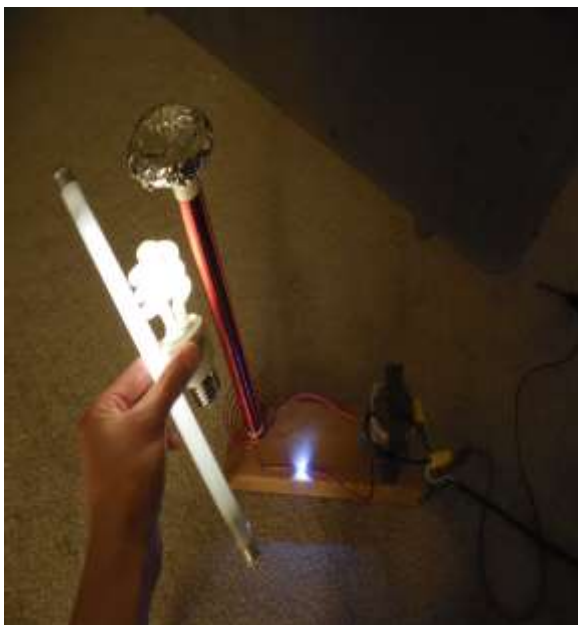
Figura 5. Lámparas encendidas con una bobina de TESLA.
