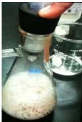
Figura 6. a) Sistema listo para ejecutar reacción. b) reacción de descomposición del H 2 O 2 .
