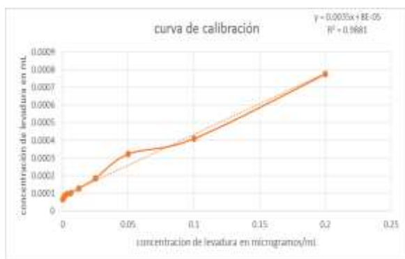
Gráfica 1: se observa la curva de calibración a partir de las concentraciones presentes en cada tubo y las concentraciones de biomasa obtenida por el espectrofotómetro. También se observa la ecuación de regresión lineal y el coeficiente de correlación que da veracidad a nuestros datos obtenidos.
