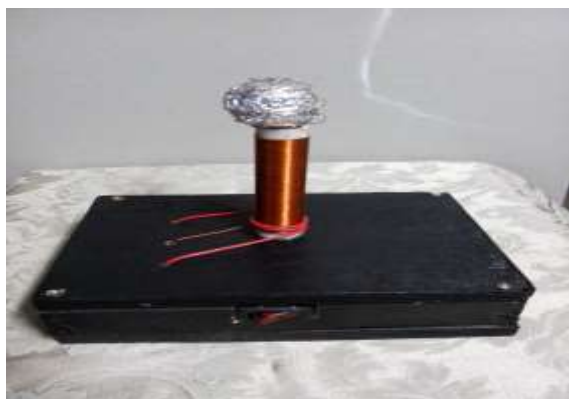
Imagen3: Bobina de tesla terminada
