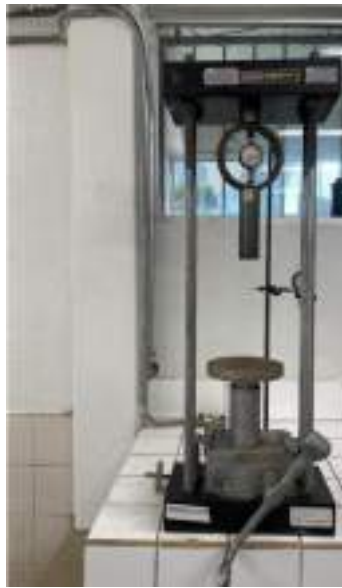
Figura 12.- Prensa VRS marca Soiltest, mod. 3t, serie: 2335 S. Del lado derecho se observa su informe de calibración.
