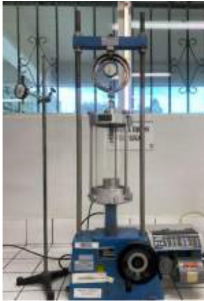
Figura 14.- Prensa Triaxial digital marca ELE-ARTECH, mod. T-1325A, serie Celda N/S 313768. Del lado derecho se observa su informe de calibración.
