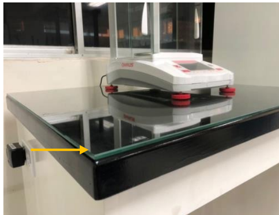
A 32.- Pieza de vidrio templado de ¼ de pulgada sobre mesa de báscula analítica.
